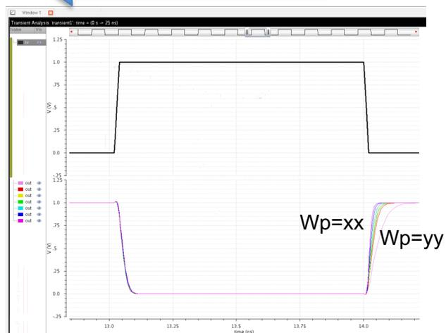
Plote na parte superior da simulação  $v(\text{iv})$  (entrada), e na parte inferior as 7 curvas  $v(\text{out})$  (saída). É uma interface gráfica padrão, só arrastar o nome da forma de onda para onde se deseja colocá-la.
