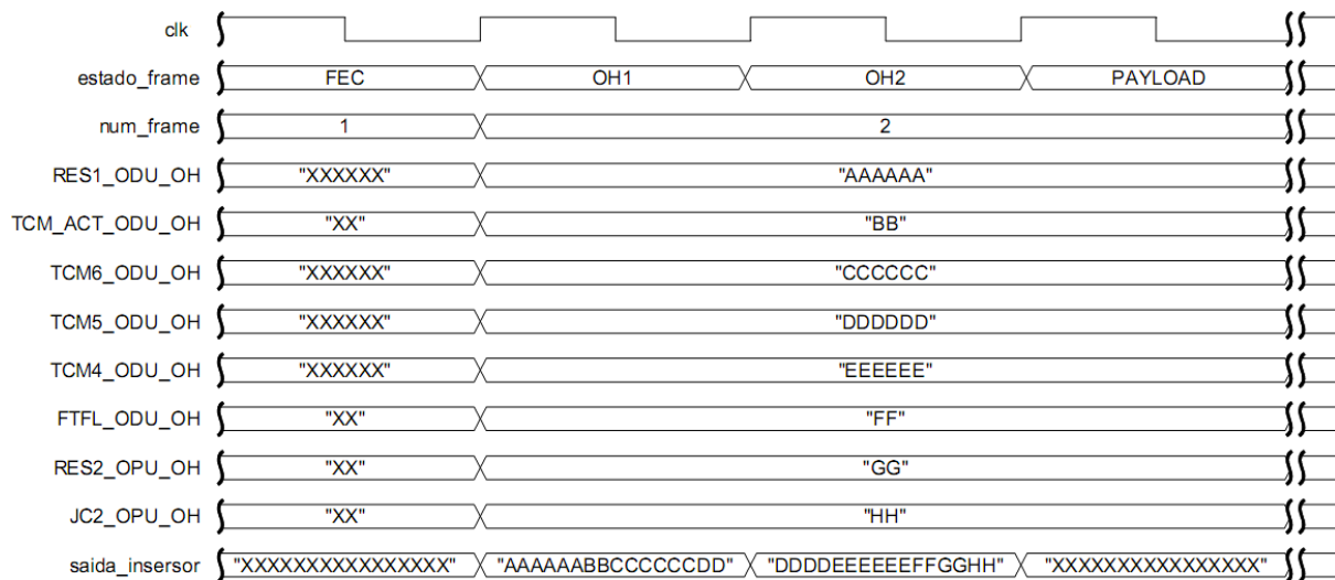
Figura 60 – Montagem do cabeçalho do segundo quadro.
