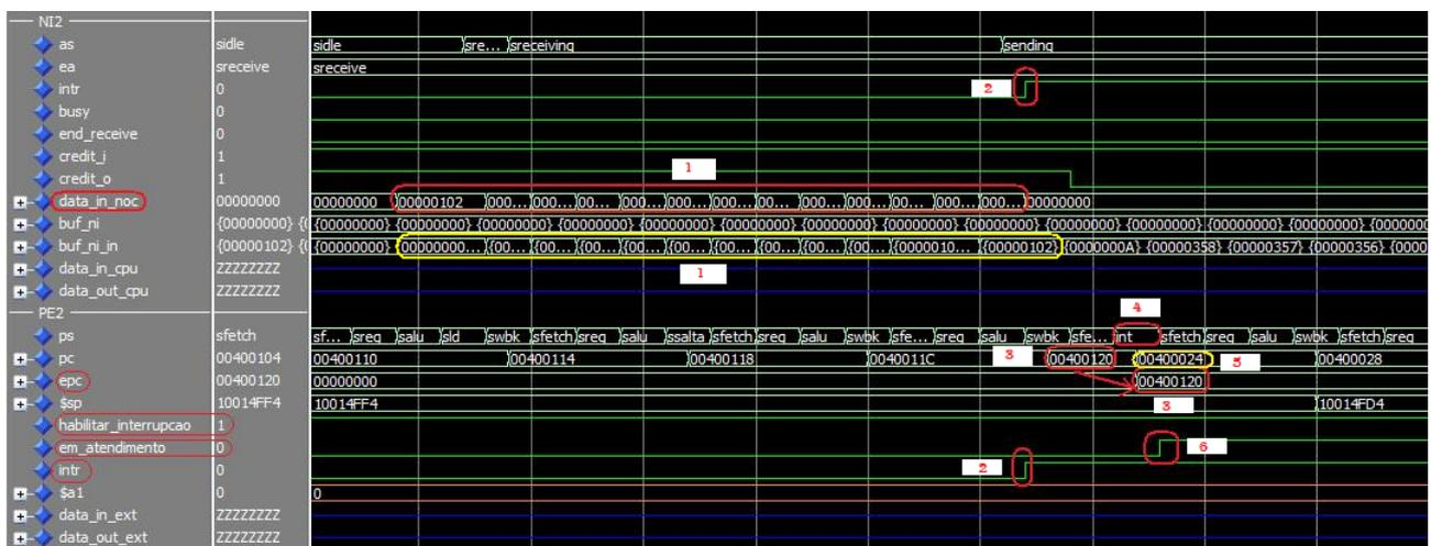
Figura 57 – Momento em que a chamada da interrupção é executada quando a NI necessita enviar um pacote para o processador.
