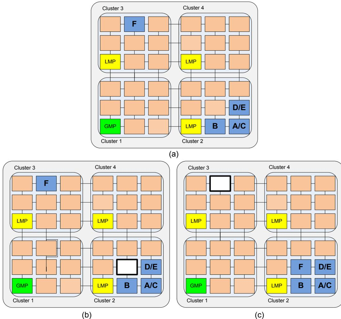
Figura 33 – Exemplo de reclusterização usando migração de tarefas.
